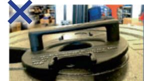
Si l'axe de la jauge rentre en totalité dans le verrouillage, la limite d'usure est atteinte
