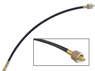
FLEXIBLE POUR ROUES EXTÉRIEURES Ref. GETR 60010004 Déport 0°, pour monte simple ou jumelée. Tout essieux.
